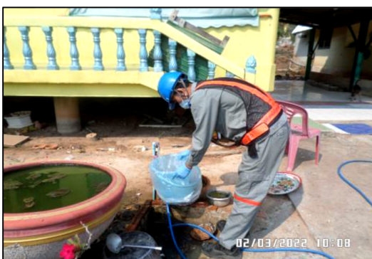
ภาพที่ 3.23 การตรวจวัดคุณภาพน้ำใต้ดิน บริเวณน้ำบาดาลชุมชนบ้านเขาเตียน
