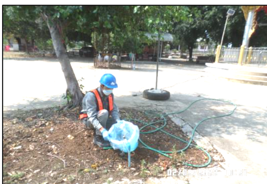
ภาพที่ 3.22 การตรวจวัดคุณภาพน้ำใต้ดิน บริเวณน้ำบาดาลชุมชนบ้านห้วยยาง
